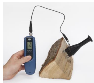
Fig. 3.2 Principiul determinării umidității lemnului prin procedeu electric 1 - electrozi; 2 - circuit electric; 3 - scudă pentru citirea umidității; 4 - piesă din lemn.
